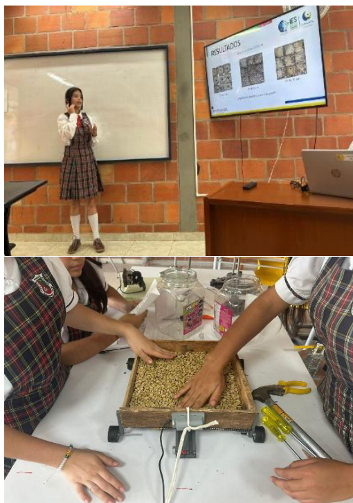
Imagen 1. Estudiantes realizando pruebas de volteo del café por vibración.
